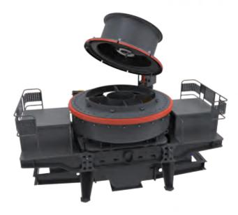
机器关键部位采用一流合金材质,配备优质 NSK 轴承和 P54/55 防护等级的电机(西门子可选),确保了 B系列深腔立轴冲击破碎机在任何工况条件下都能闪耀出卓越的品质之光。
