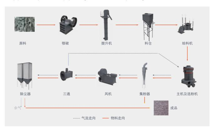
经由给料机送入主机的物料经主机磨粉,产生的粉子随风机气流上升,经由选粉机进行分级,符合细度要求的粉子随气流经管道进入旋风集粉器中。
