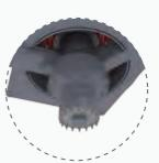
排矿口调节。配置主轴位置控制系统,可以通过液压系统控制 主轴,方便调节排矿口大小,还可以补偿衬板磨损,控制产品 粒度。
